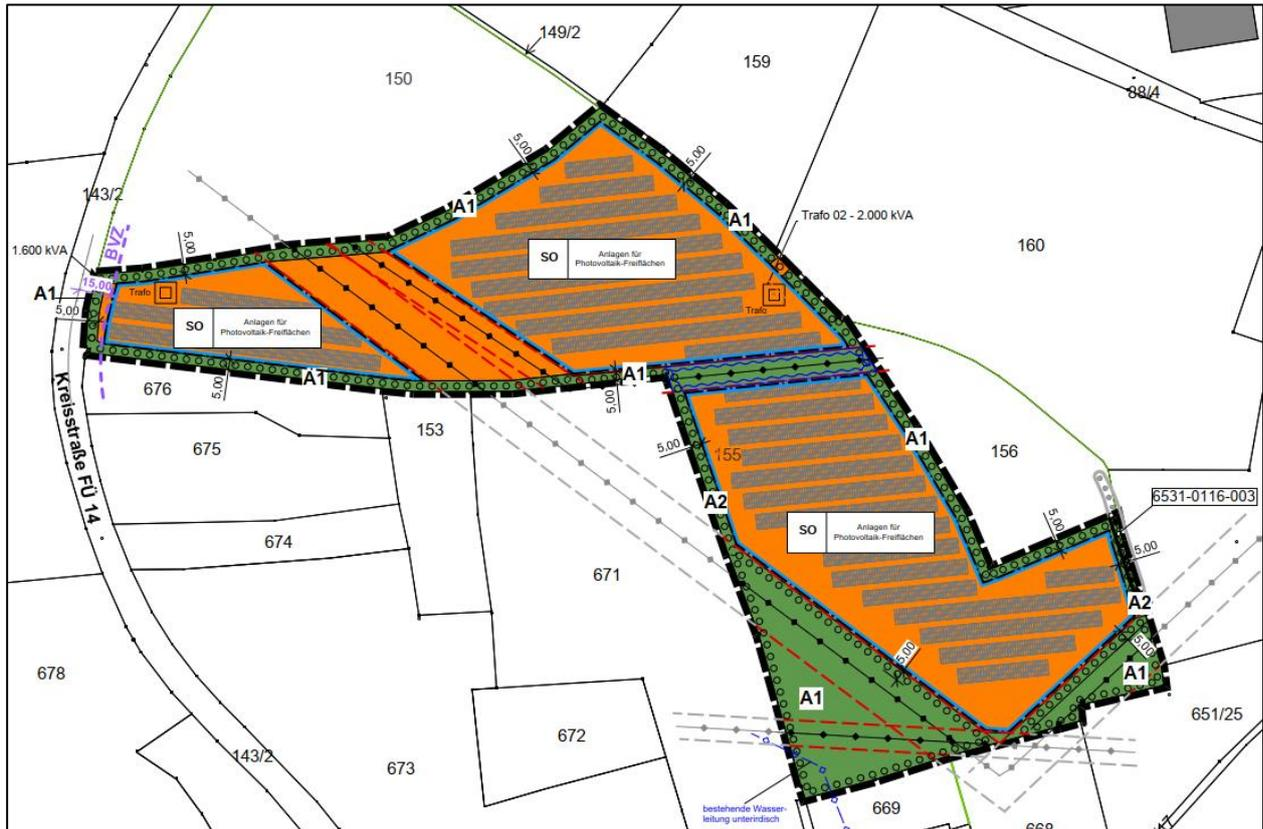
Die Sondergebietsflächen werden im Bereich des namenlosen Grabens geteilt, um negative Auswirkungen auf den Hochwasserabfluss zu vermeiden. Eine Überbauung dieses Bereiches mit PV-Anlagen ist unzulässig.
