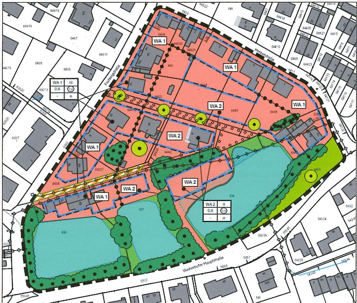
Auszug aus dem Planblatt des Bebauungsplans „Weiher“ Schwarz gestrichelt umrandet der Geltungsbereich des Bebauungsplans; ohne Maßstab (© Kartengrundlage: Bayerische Vermessungsverwaltung 2023)
